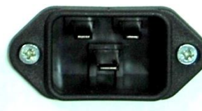
Rys.3. Gniazdo zasilania, tył wirówki
