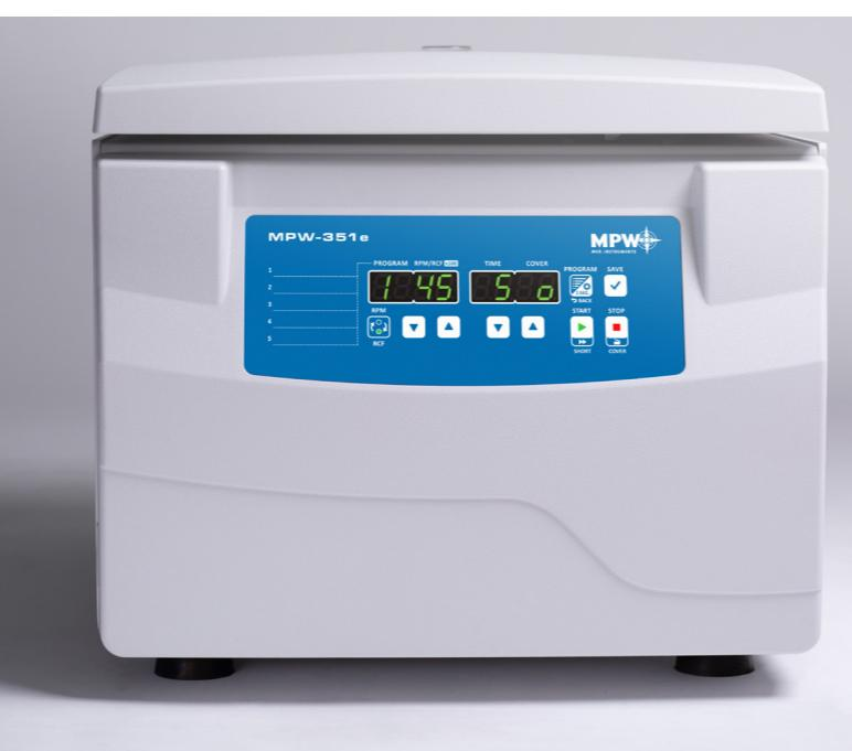
Intuicyjny interfejs użytkownika pozwala na precyzyjne wybranie parametrów RPM i RCF, wybór charakterystyk rozpoczęcia [FAST, SOFT] i hamowania [FAST, SOFT, LONG, RUN]. Pozwala także na szybkie utworzenie i zapisanie 5 programów w pamięci z możliwością zanotowania ich nazw i parametrów na panelu sterowania.
